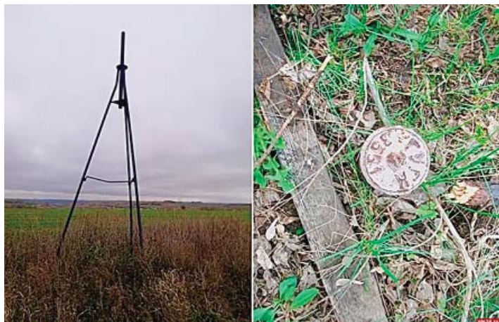
Геодезический знак и грунтовый репер
