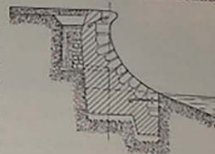
Рис. 1. Волноотбойная стена (разрез).
